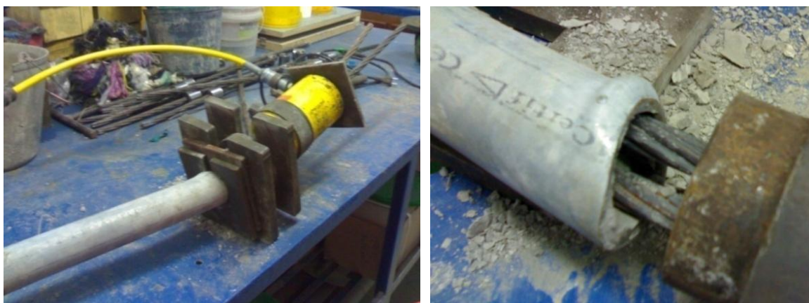
Figura 4.22 - Deformação do tubo metálico nos ensaios de tracção.
