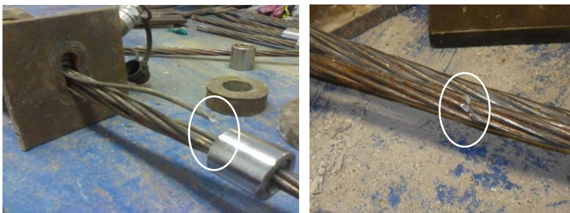
Figura 4.21 - Ruptura dos cabos de aço nos ensaios de tracção.
