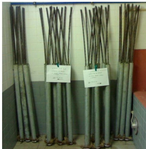
Figura 4.17 - Armazenamento dos provetes na câmara húmida para os ensaios de tracção.
