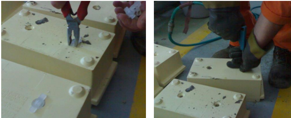
Figura 4.11 - Desmolde dos provetes cúbicos: recolha de tampas dos moldes (esq.); extracção dos provetes cúbicos através de uma pistola de ar comprimido (dir.).
