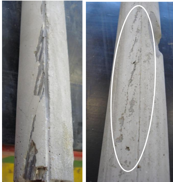
Figura 4.26 - Posição do cabo no interior da calda (esq.); Registo do deslocamento do cabo no interior da calda (dir.).
