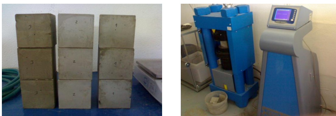
Figura 4.13 - Ensaios de resistência à compressão: Organização dos provetes, 3 para cada tipo de calda (esq.); Equipamento de ensaio de resistência à compressão uniaxial (dir.).
