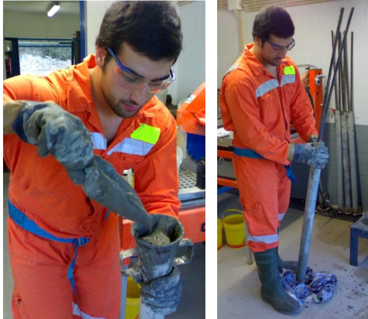
Figura 4.16 - Colocação da calda e cabos de aço no tubo metálico.
